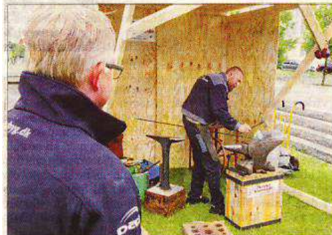
Smedene har gang i essen og ambolten for at lave bolte, nagler og beslag til skibet.
