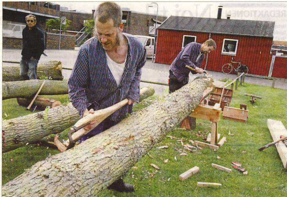
De svenske tømrere er eksperter i blandt andet afbarkning af egetræsstammer. Barken blev i gamle dage anvendt til garvning af huder.
